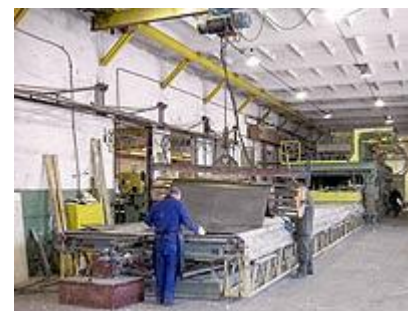
Пресс по изготовлению сэндвичей-панелей
