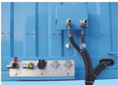
Соединительный элемент с тягачем. Вверху напорная и сливная магистральная гидросистема.
