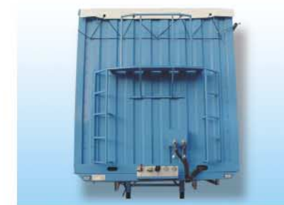
Смотровая площадка на переднем борту
