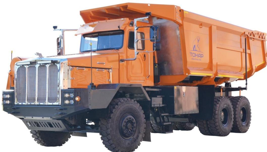
Машина ТОНАР 7501 – предназначена для перевозки грузов в карьере по технологическим дорогам. Сконструированы и произведены машиностроительным заводом «ТОНАР» в соответствии с современными требованиями рынка.
